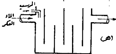
هـ- المنج يتم بمرور المياه بين الحوائث الرأسية وهو قطاع رأسي
