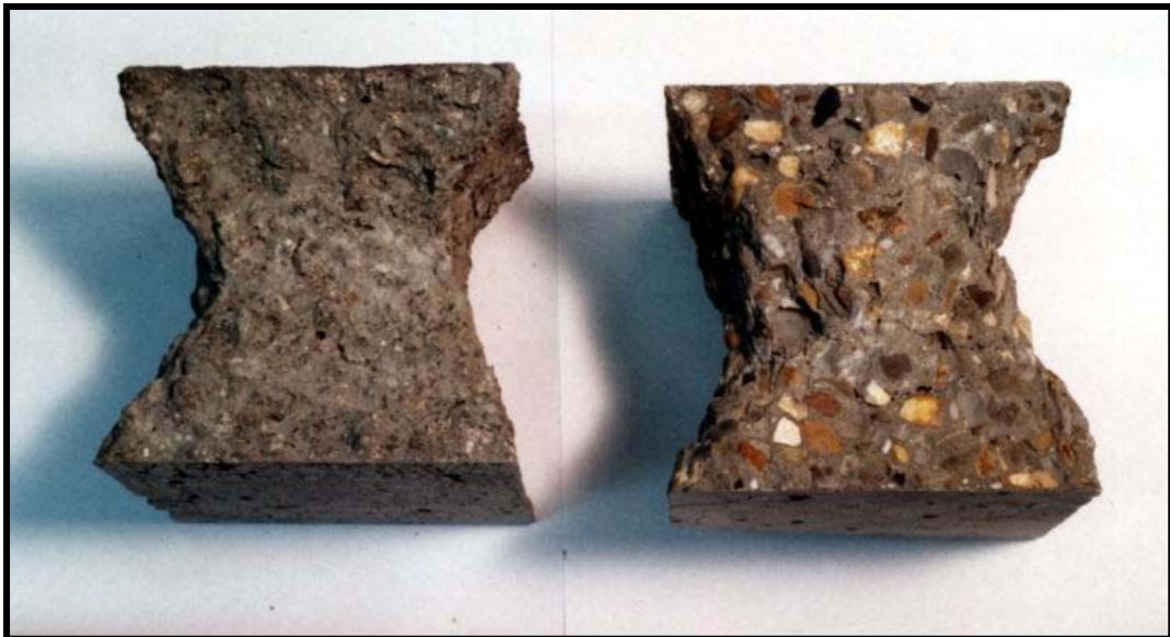
شكل (٨-١٩) الكسر للعينات المكعبة في إختبار مقاومة الضغط.
