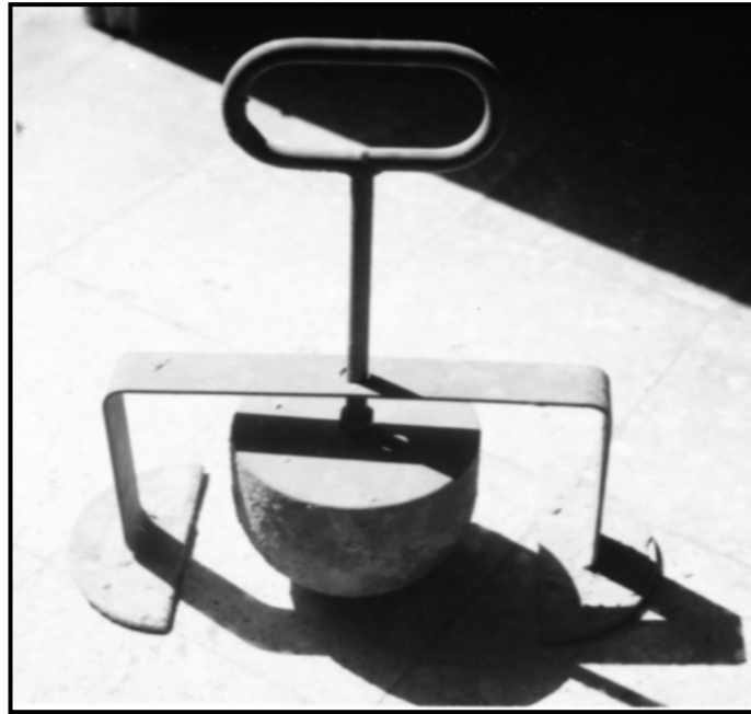
شكل (٧-٩) جهاز كرة كيلى لقياس القوام.
