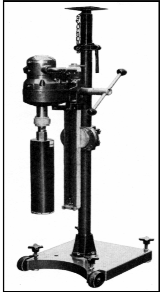
شكل (٩-١٦) جهاز القلب الخرساني وأخذ عينة أفقية من حائط.
