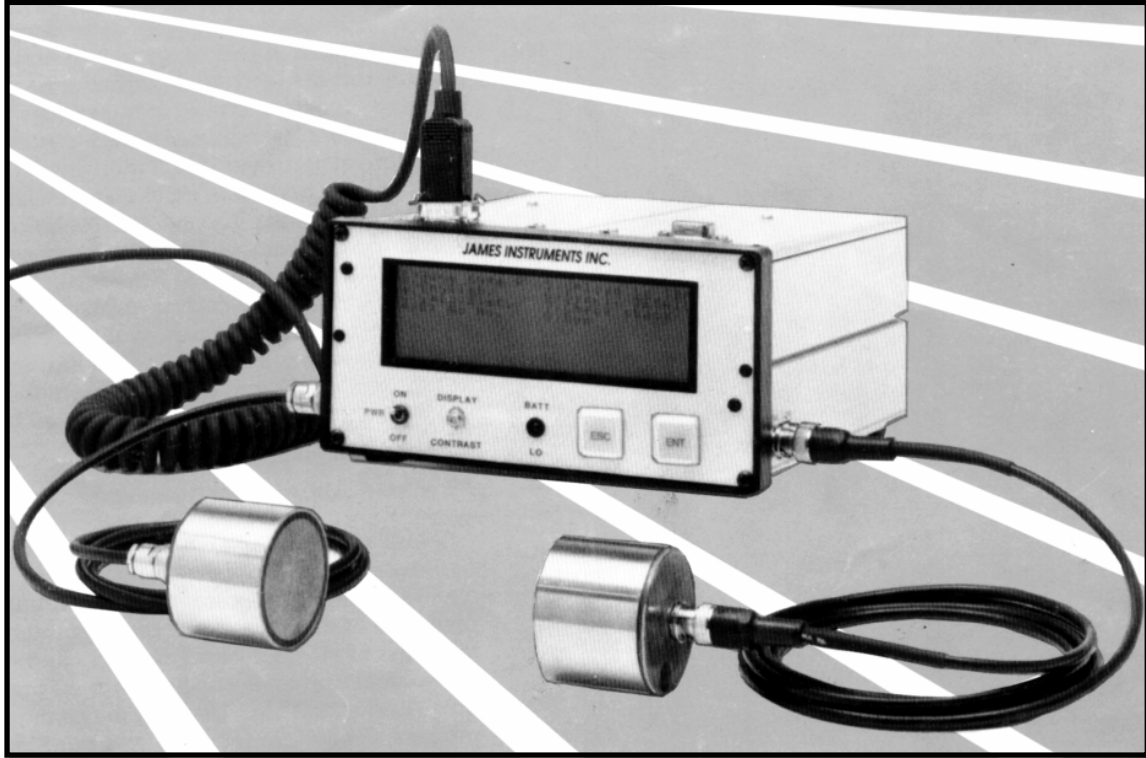
شكل (٩-٤) جهاز الموجات فوق الصوتية الشائع الإستخدام في مجال الخرسانة.
