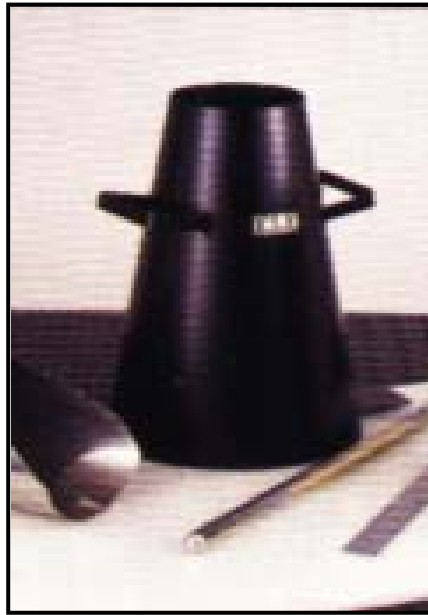
شكل (٧-٢) قالب اختبار الهبوط وقضيب الدمك.
