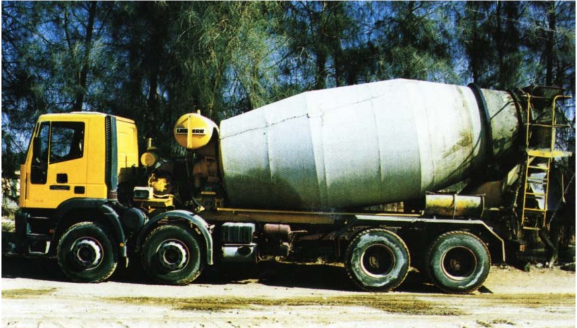
شكل (٤-٢) عربة خلط خرسانة سعة ١٠ متر مكعب.
