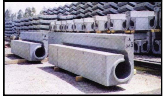
مجارى خرسانية لتصريف مياه الأمطار (نفق الأزهر)
