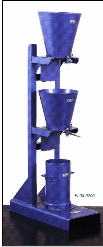
شكل (٧-١٢) جهاز عامل الدمك.
