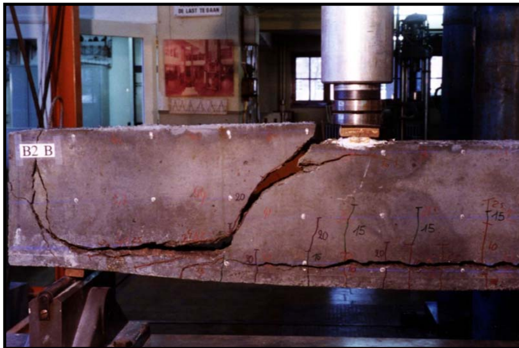
شكل (٨-٢٩) انهيار قص (شد قطري) في كمر من الخرسانة المسلحة بدون كانات.
