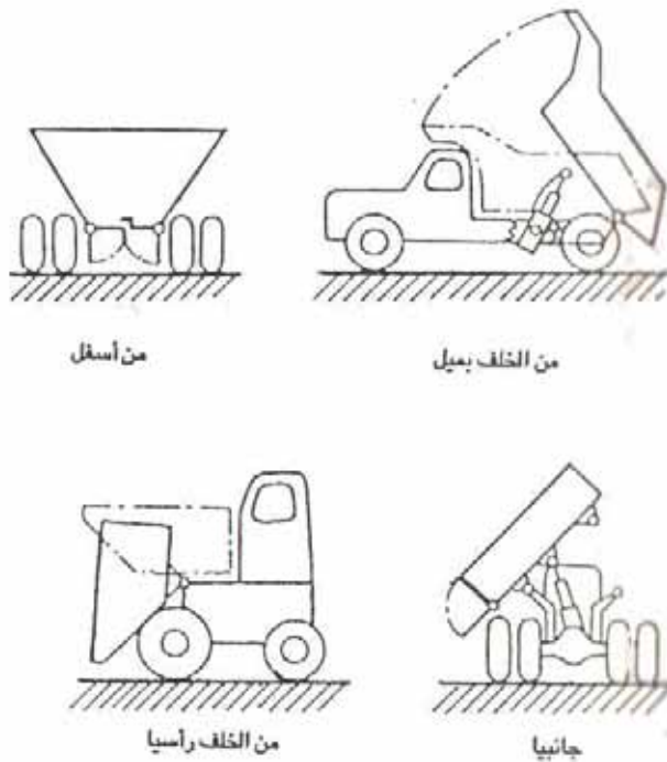
شكل (٣٢) الأشكال المختلفة لتفريغ صندوق اللورى
